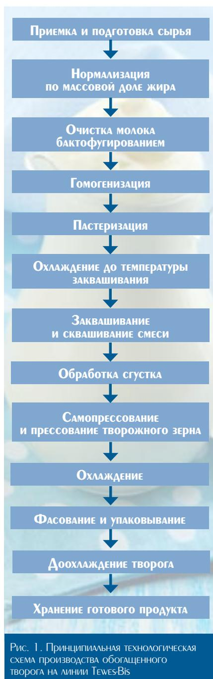
Рис. 1. Принципиальная технологическая схема производства обогащенного творога на линии Tewes-Bis
